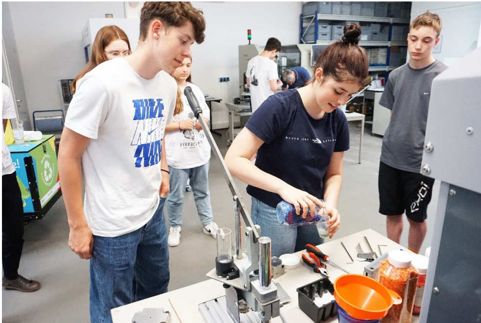
Schülerinnen und Schüler an der Handspritzgussmaschine – Herstellung neuer Formteile aus recyceltem Material
