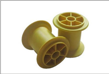
Spritzgegossene Garnspulen (gelb eingefärbt) aus PLA 6202 /GN 40 (60/40 w/w)
