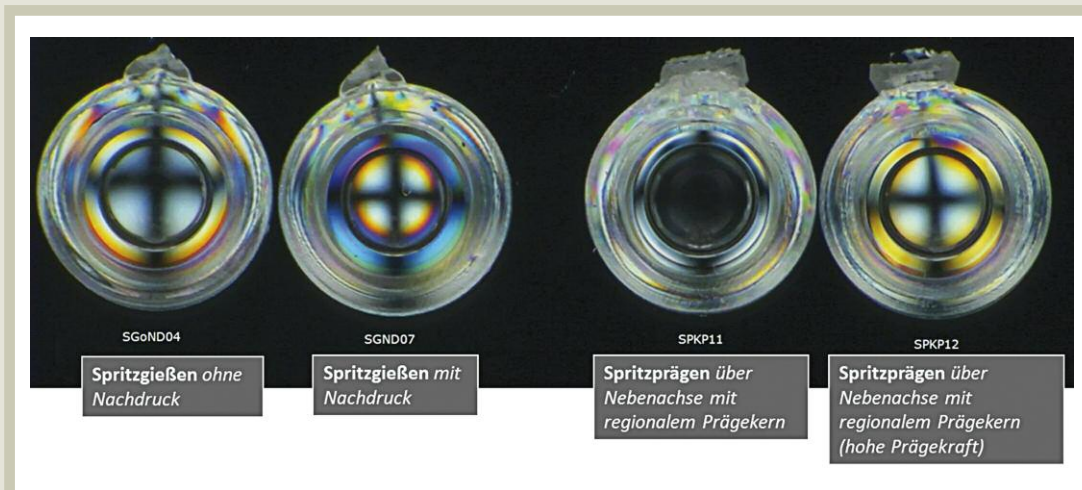
Bild 5. Vergleich der Eigenspannungen mittels Polarisationsmikroskopie einer Zylinderlinse aus PC, hergestellt in verschiedenen Verfahrensvarianten
