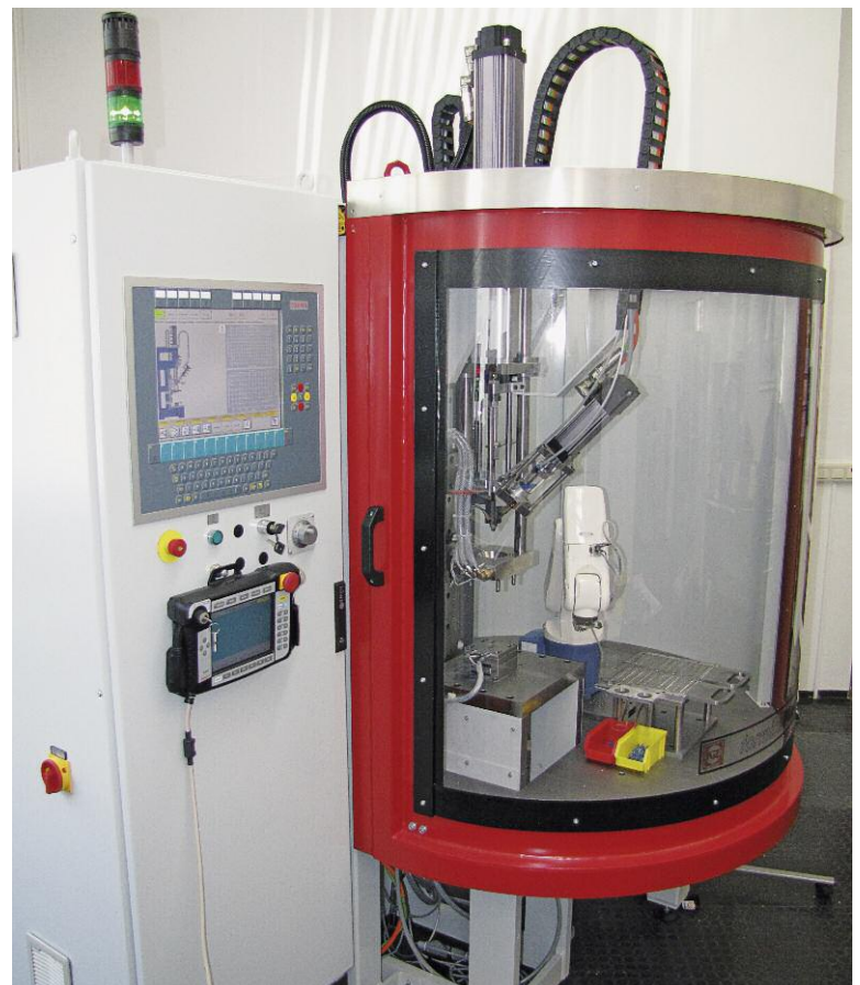
Bild 6. Vertikale Mikrospritzgießmaschine ›Formica-Plast‹ mit dynamischer Regelung, wie sie beim Spritzprägen benötigt wird
