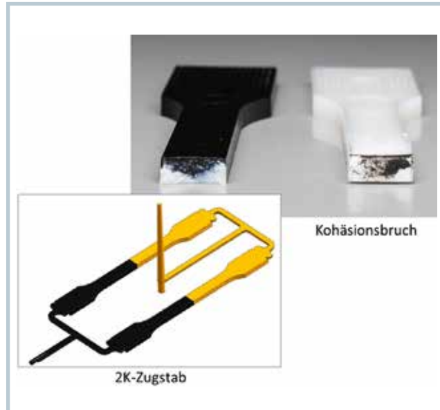
Bild 5. Der Kohäsionsbruch zeigt die gute Verbundhaftung zwischen PP-LGF40 und unverstärktem geschäumten PP (oben). Unten ist ein 2K-Zugprüfstab dargestellt (© KUZ)
