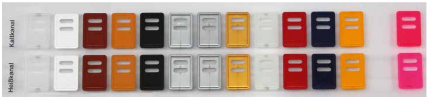
Jeweils mit Kalt- und Heißkanal spritzgegossene Musterplatten aus PP mit Monofarbpräparationen und provoziertes Binde- und Fließnaht (© KUZ)
