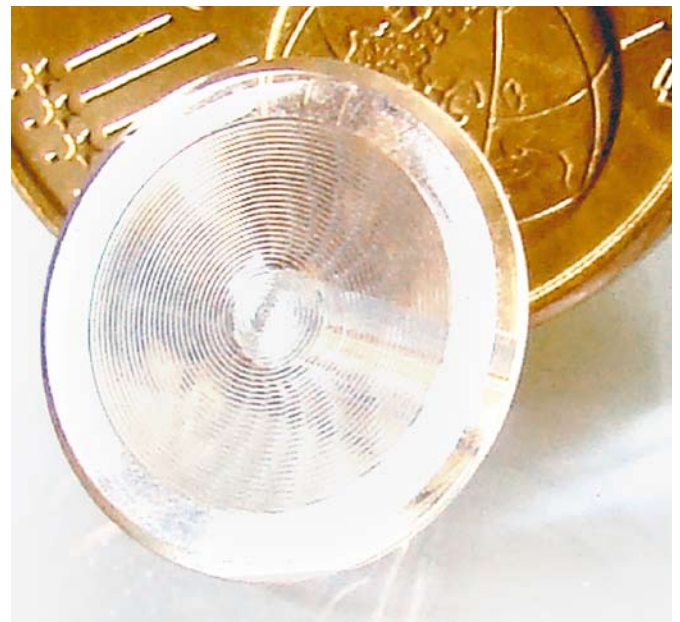
Linsen-Formteil mit mikrostrukturierter Fresnelstruktur auf einer Fläche von 6,8 \text{ mm} im Durchmesser und mit spitz auslaufender Mikrokontur mit Höhen im \mu\text{m} -Bereich
