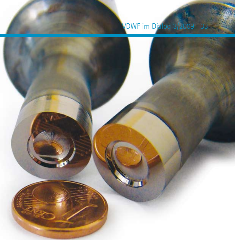
Sonotroden mit beschichteter Frontseite und ultrapräzisionsgefertigten optischen Konturen für die Herstellung von Fresnellinsen und von plankonkaven Linsen
